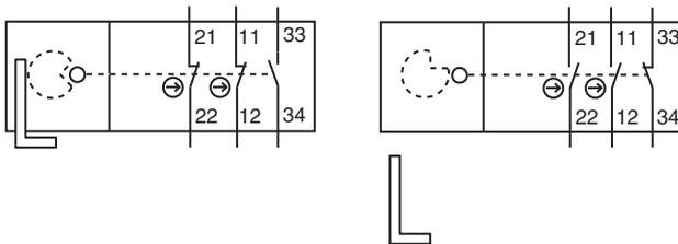
Рис. 7.3: Контактный блок 2 разм.конт. + 1 замык.конт. (S20-P4xxx)
