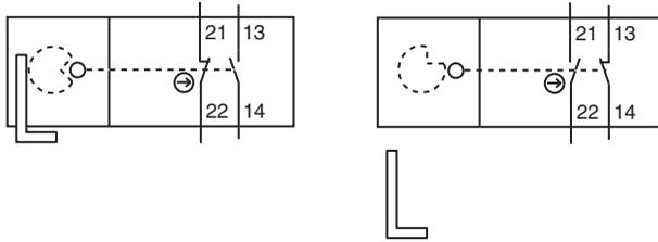
Рис. 7.2: Контактный блок 1 разм.конт. + 1 замык.конт. (S20-P1xxx)
