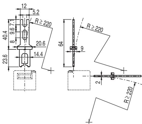
Рис. 13.5: Контактный элемент AC-AN-SL
