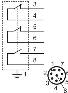
Рис. 7.4: Схема контактов 8-полюсного штекера M12 (S20-xxx-M12-xxx)
