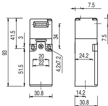
Рис. 3.1: Размеры S20-P3C1-M20-FH, S20-P1C1-M20-FH и S20-P4C1-M20-FH30 в мм
